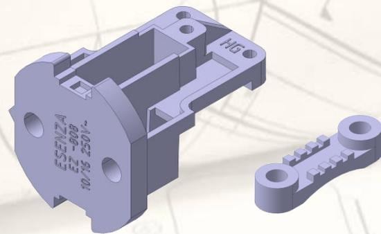
Selain bagian **body stecker**, dalam *mold* (cetakan) ini dibuatkan juga untuk bagian **clamp stecker**. **Clamp** ini berfungsi sebagai pengikat kabel.
